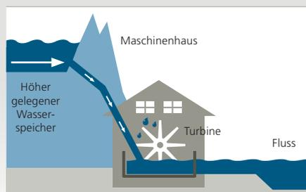
Wasser wird gespeichert und fließt durch ein Rohrleitungssystem zu den tiefer liegenden Turbinen im Kraftwerk. Dieser Typ ist ideal zur Deckung des Strombedarfs in Spitzenzeiten.
