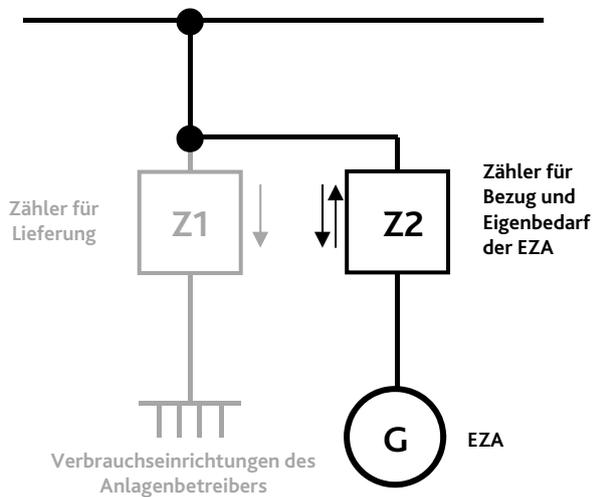
Überschusseinspeisung PV bis 10 kW
